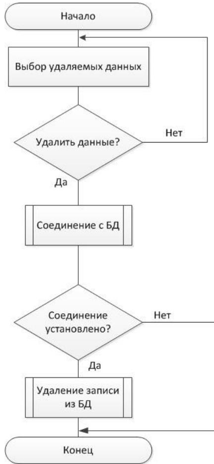
Рисунок 1.5 – Схема алгоритма удаления записи в БД
